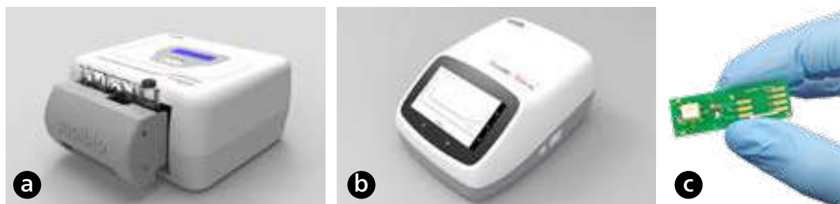
Figura 1.3 Equipo de Molbio para realizar las pruebas Truenat MTB, MTB Plus y MTB RIF Dx: a) equipo Trueprep para preparar las muestras, b) equipo Truelab Uno Dx de PCR en tiempo real para realizar las pruebas, y c) chip para PCR en tiempo real
